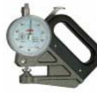
Đồng hồ đo độ dày màng mỏng độ phân giải 0,1mm, 0,01mm
